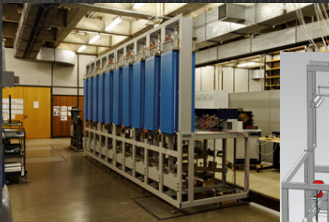
Beispiel für Zeitstandprüfungssystem mit integrierten Öfen
